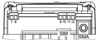
обозначение контактов счетчика с GSM-модулем
